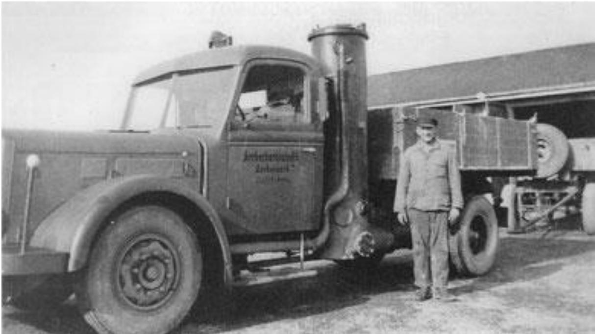
Een vrachtwagen met open laadbak en met een hout gestookte gasgenerator
